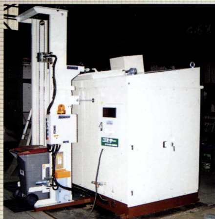
投入用リフト(容器移動式)
